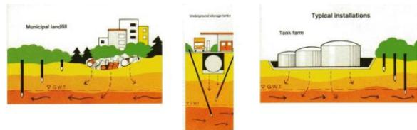
圖二十三：各種狀況監測剖面示意圖
