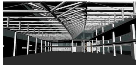
圖十一 輕量鋼構設計及開放式活動隔間
