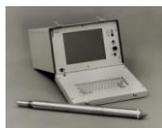
圖八：系統電腦及電子錐
