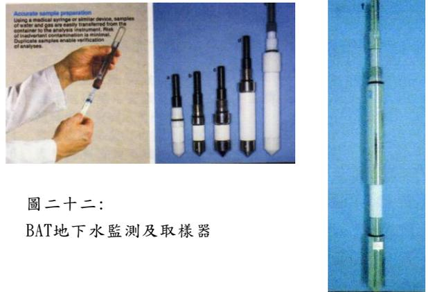
圖二十二：BAT地下水監測及取樣器
