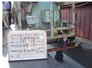
照片 4-3 連續壁體超音波檢測
