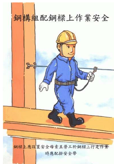
圖 高度2公尺以上開口作業應確實使用安全帶等防護具
