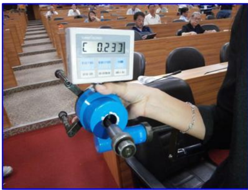
圖 日本簡易型磁磚拉拔機：(依型號會有所不同)
