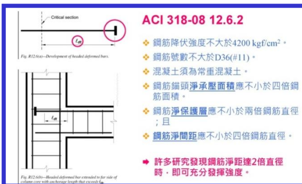
圖 擴頭鋼筋(機械式錨頭)之規範要求
