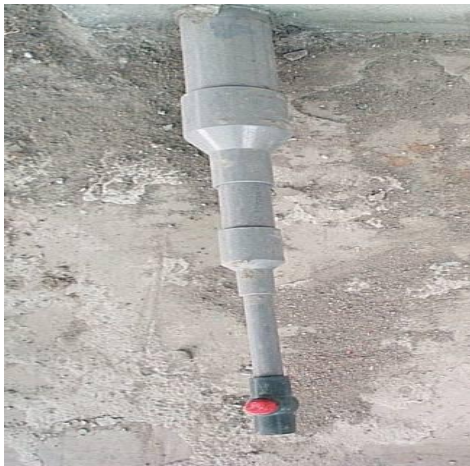
圖 49 排水測試底部裝置排水閥
