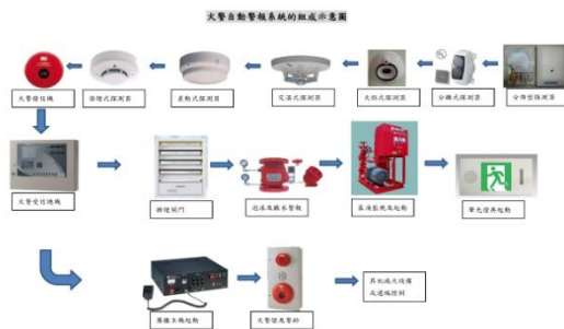
圖 4 火警自動警報系統的組成
