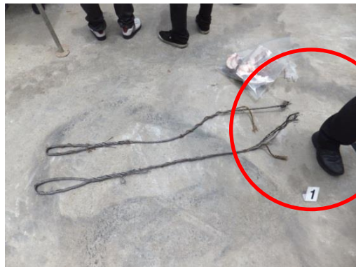
圖 吊掛鋼索斷裂。
