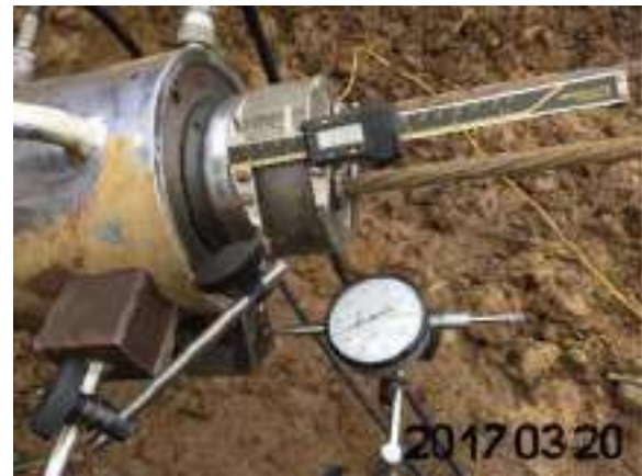
圖 55 以游標卡尺及測微計讀取伸長量及壁體變位量
