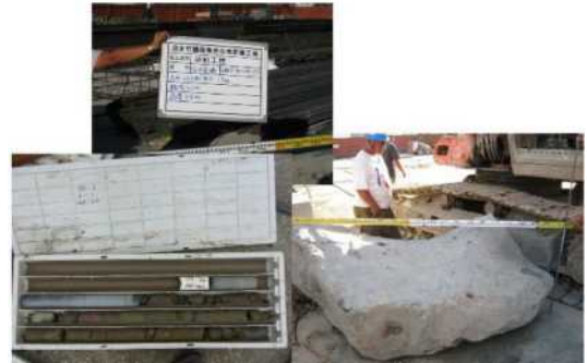
照片二 探岩岩心箱與實際抓掘安山岩塊
