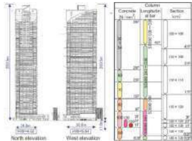
圖 27 MS Tower 柱尺寸及鋼筋混凝土規格
