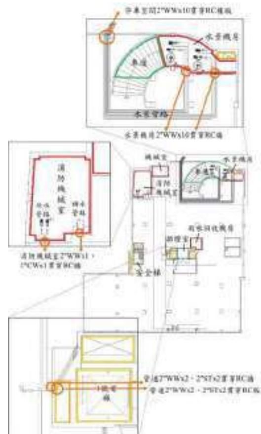
圖 7.地下 2 層給排水管路貫穿防火區劃位置
