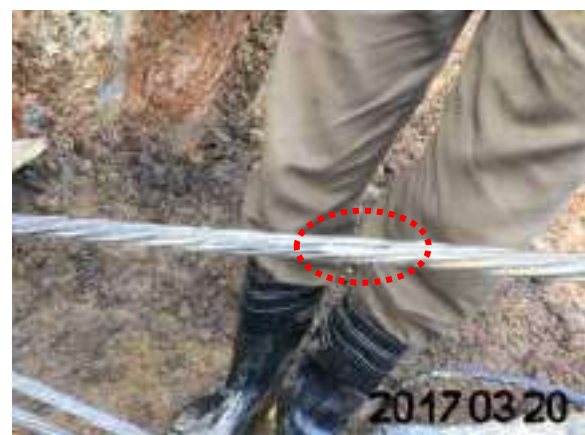
圖 56 鋼絞線之 1 股達極限應力斷裂
