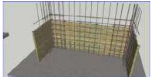
牆內側垂直鋼筋綁紮
