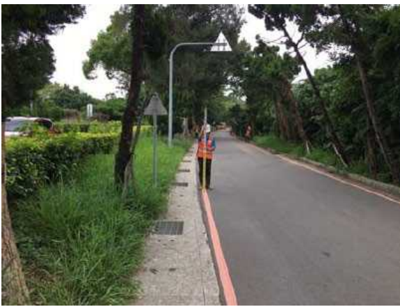
圖 69 沉陷觀測釘量測
